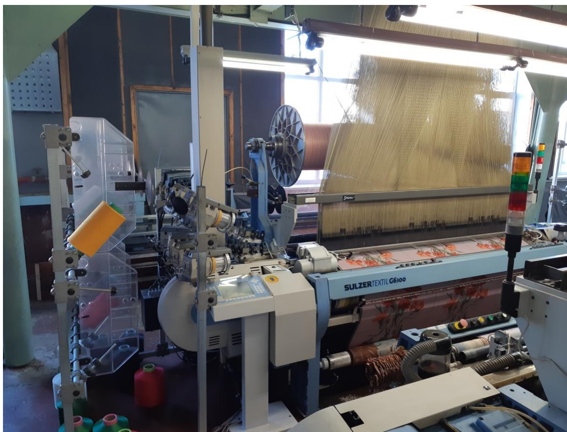
Рис 1. Современный станок для производства жаккардовых тканей (АО «Узор», пос. Вырица, Лен. обл.)
