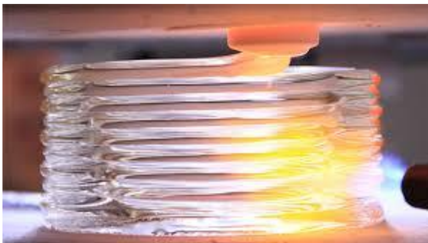
Рис. 3. Современный способ 3D печати расплавленной стекломассой
