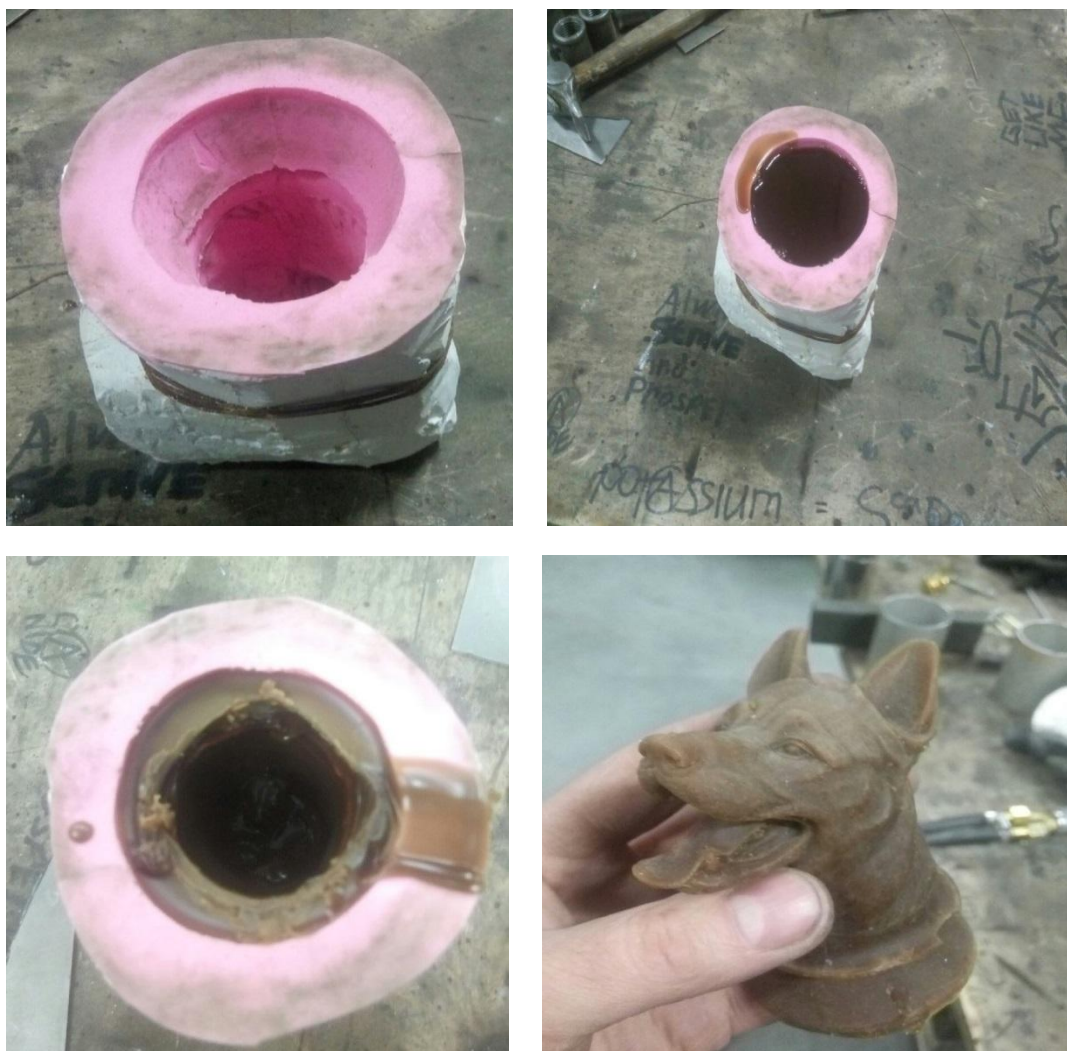
Рис. 43. Этапы получения корковой восковой модели
