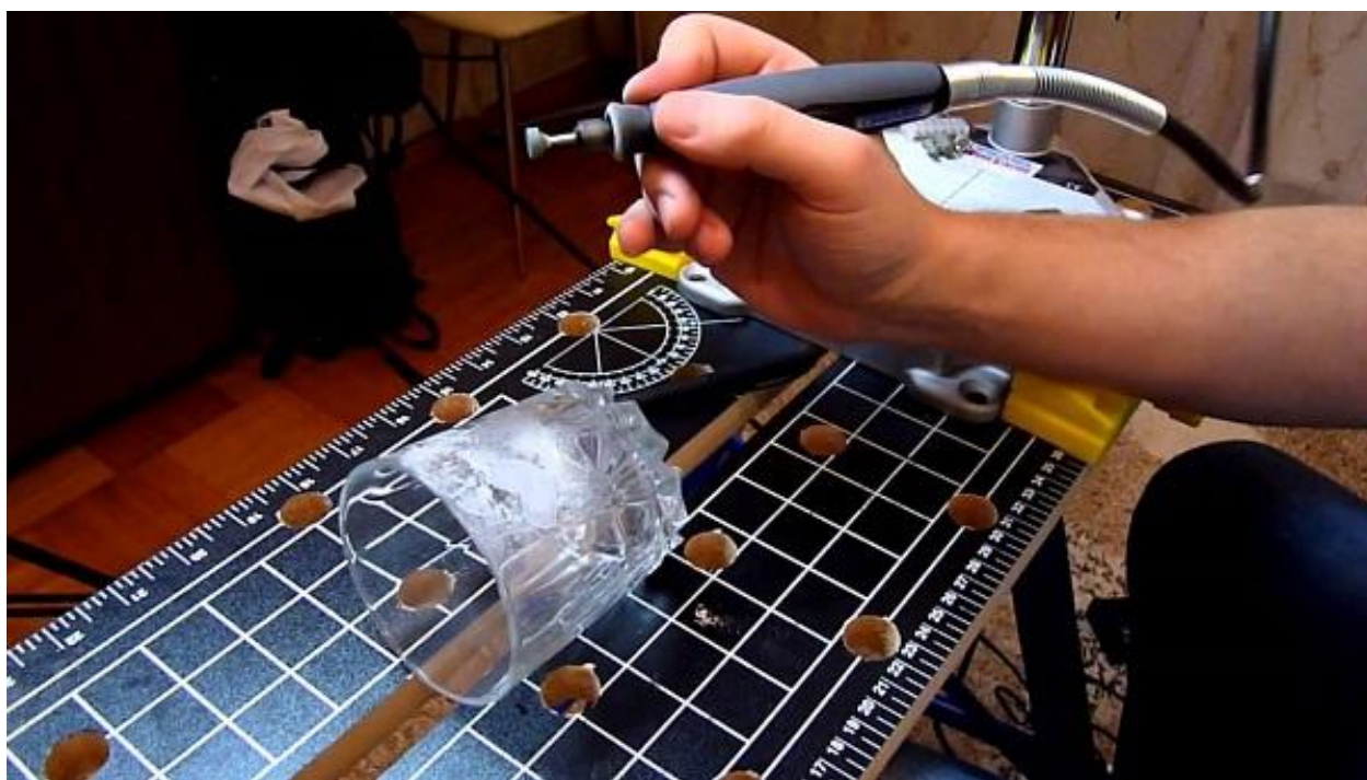
Рис. 55. Алмазные боры и пример работы с бормашинкой
