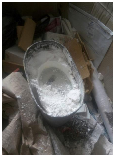
20. «Вскрытие» формы после моллирования. 1 Этап
