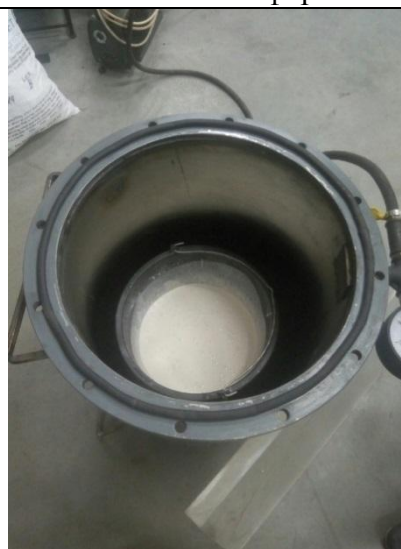
10. Установка в вакуумную камеру
