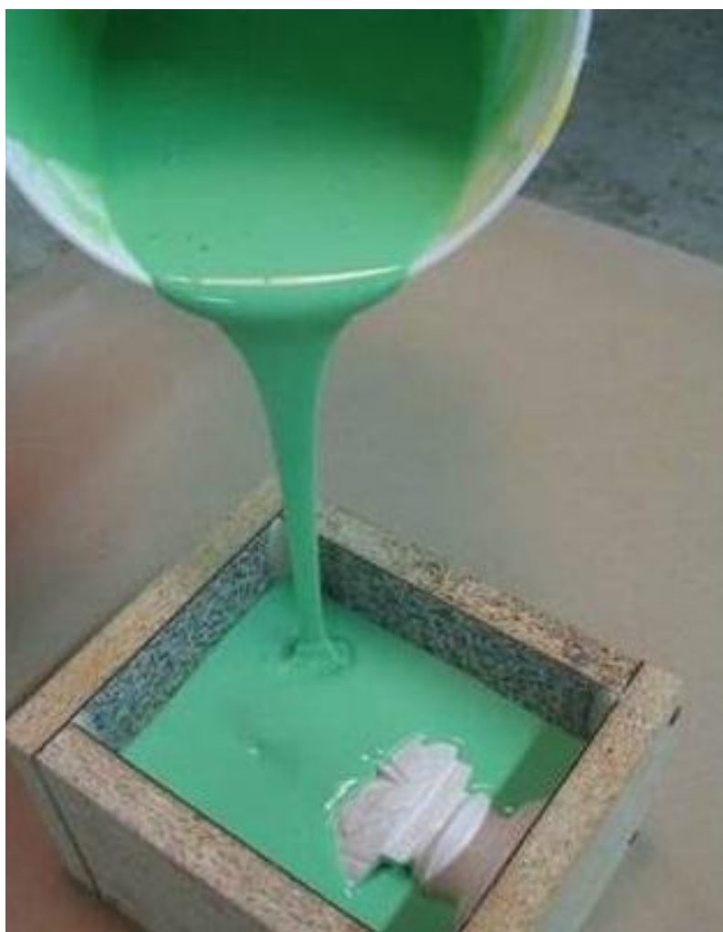
Рис. 40. Заливка модели вакуумированной массой
