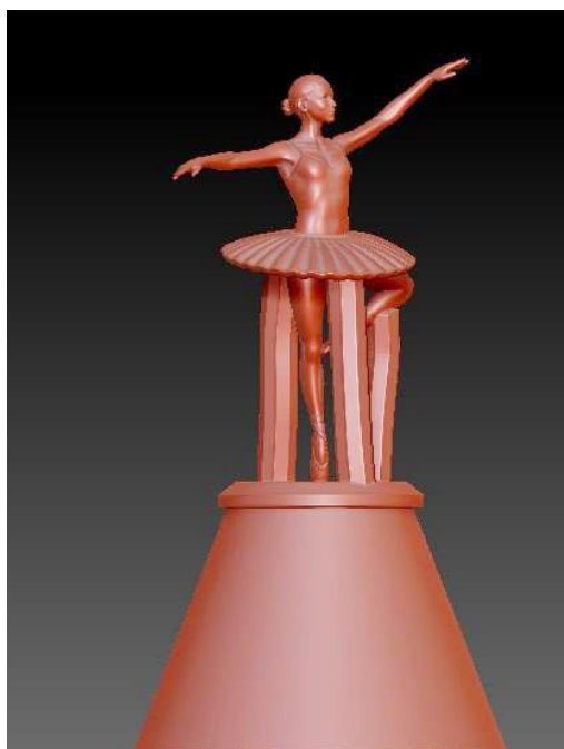
Рис. 47. Восковая модель «Балерина» на литниковой чаше и с литниковыми каналами
