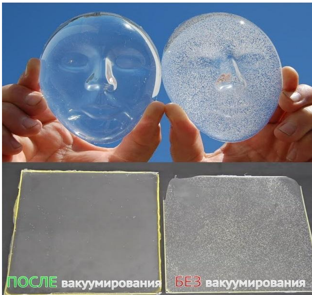
Рис. 39. Примеры качества формы с вакуумированием массы и без
