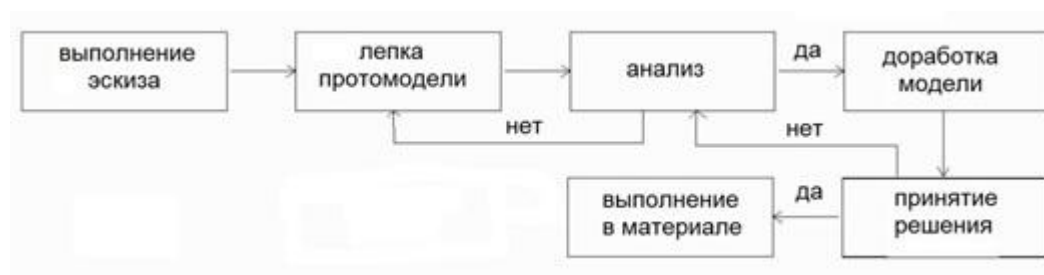
Рис. 31. Схема изготовления модели в процессе моделирования
