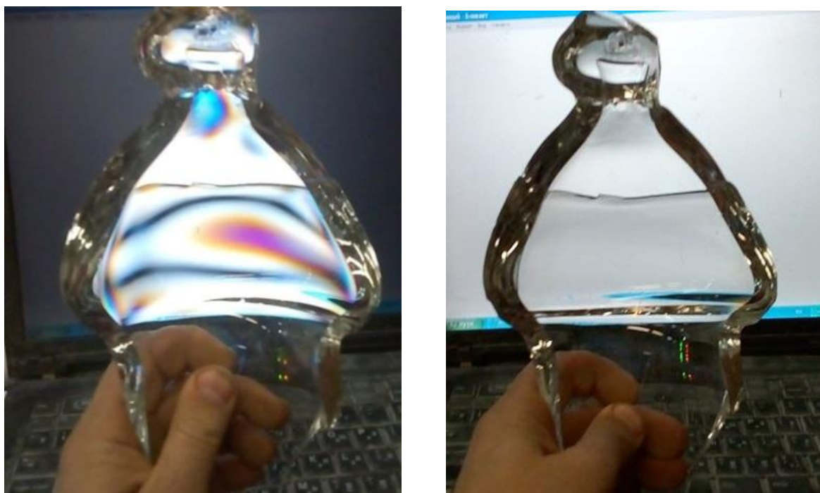
Рис. 29. Фотография стеклянного плохо отожжённого объекта в поляризованном и не поляризованном проходящем освещении
