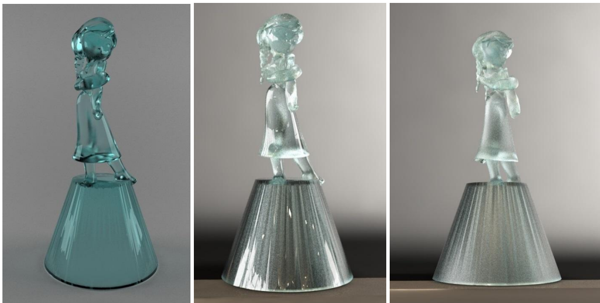
Рис. 57. Три типа фактурной кислотной обработки поверхности
