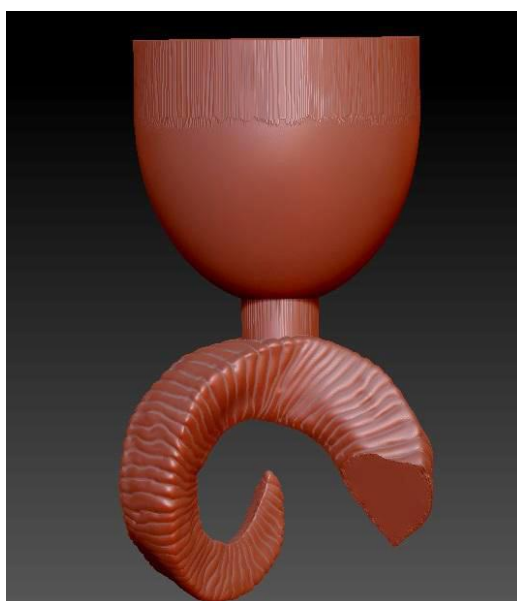
Рис. 46. Восковая модель «бараний рог» с установленным литником
