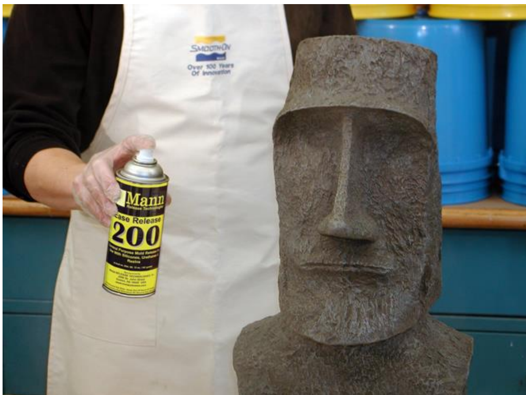
Рис. 35. Нанесение воскового разделительного слоя на модель
