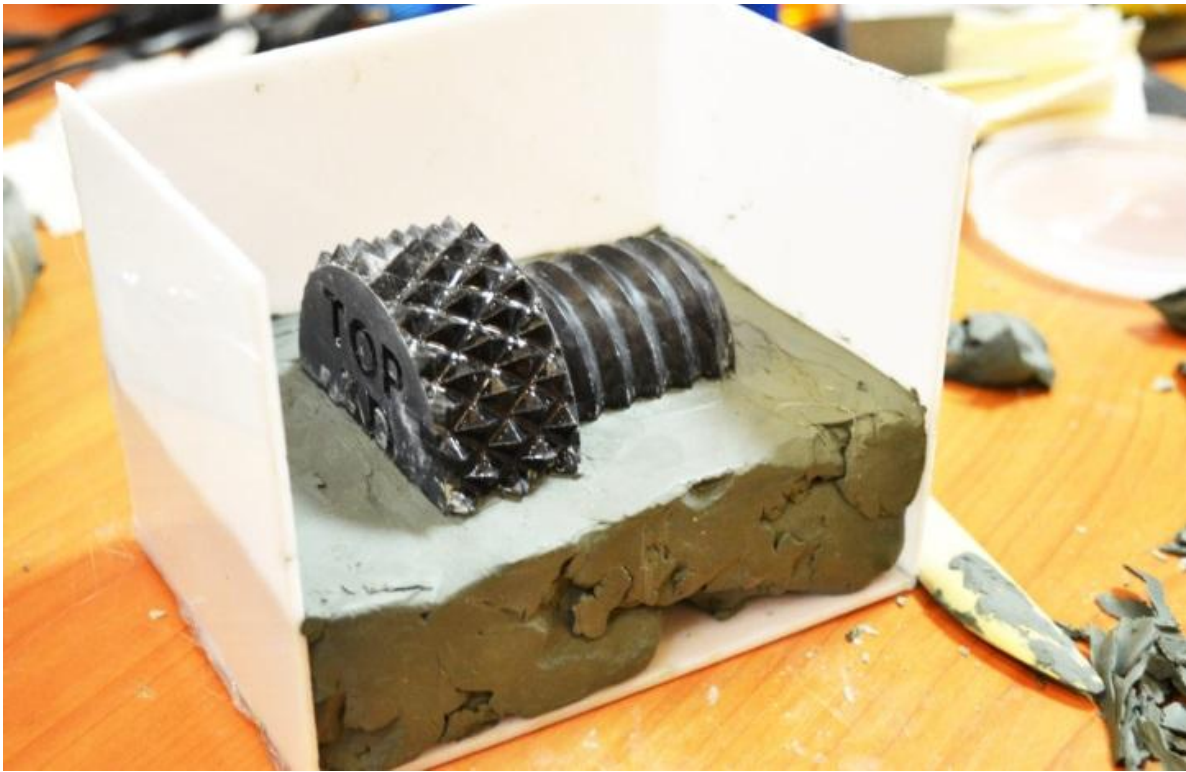
Рис. 36. Установка ограничительных бортиков вокруг модели
