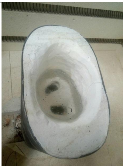
19. Форма со стеклом после окончания процесса моллирования
