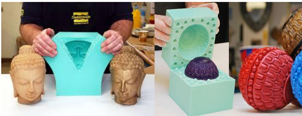
Рис. 44. Процесс извлечения восковых моделей из формы
