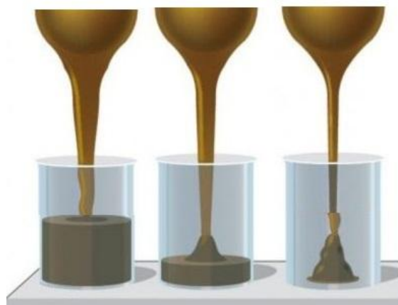
Рис. 28. Схема скорости заполнения объёмов вязкотекучей жидкости в зависимости от диаметра отверстия истечения
