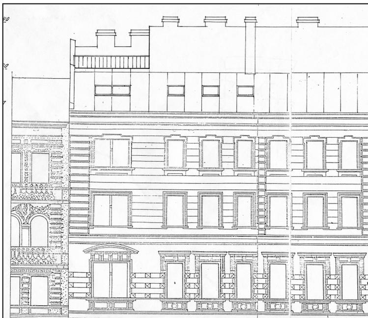
Внешний вид фасада дома по ул. Разъезжей, где планируется переоборудовать чердачное помещение под мансардный этаж. Окна на мансарде расположены строго над окнами на фасаде здания.
