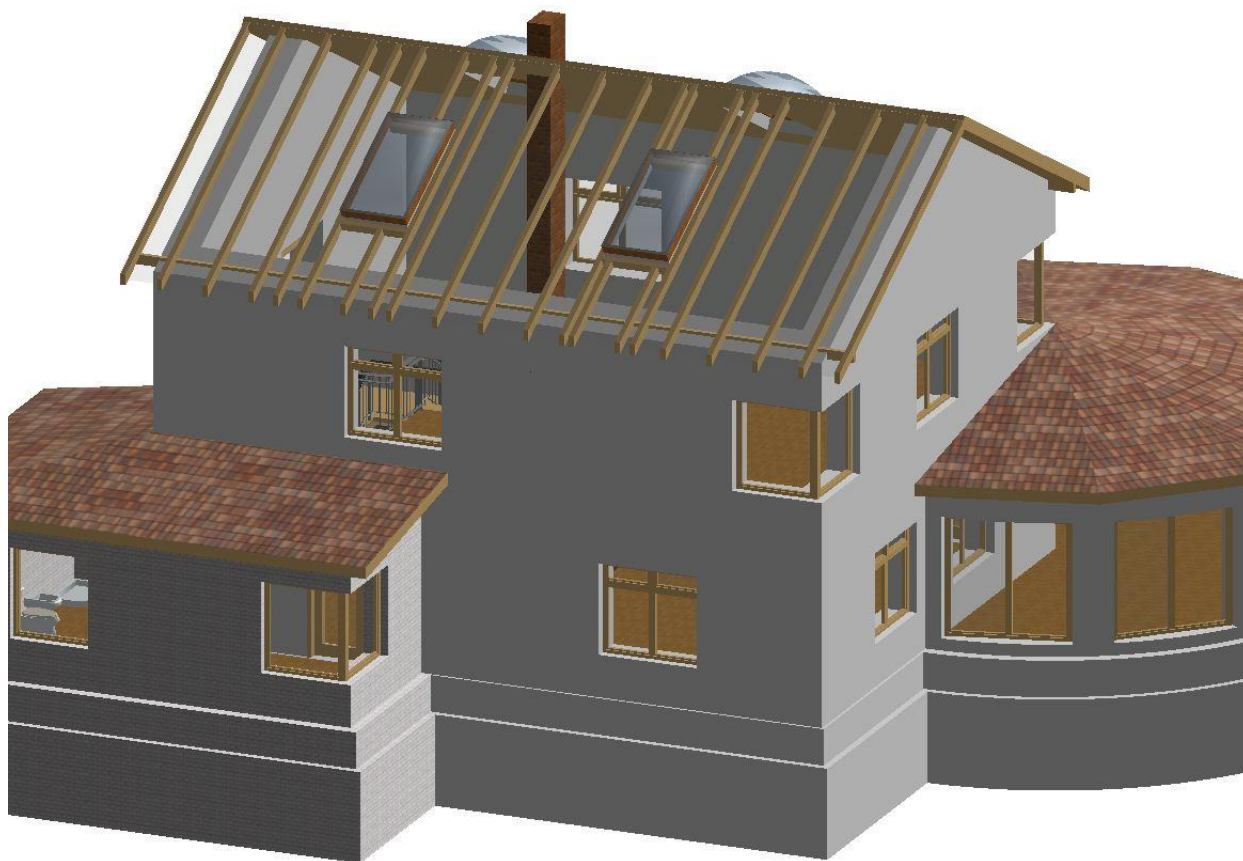
Рис. 4.5 Вид на дом с противоположной стороны. Один из скатов крыши сделан из стекла для показа устройства несущей конструкции крыши и внутреннего пространства второго этажа
