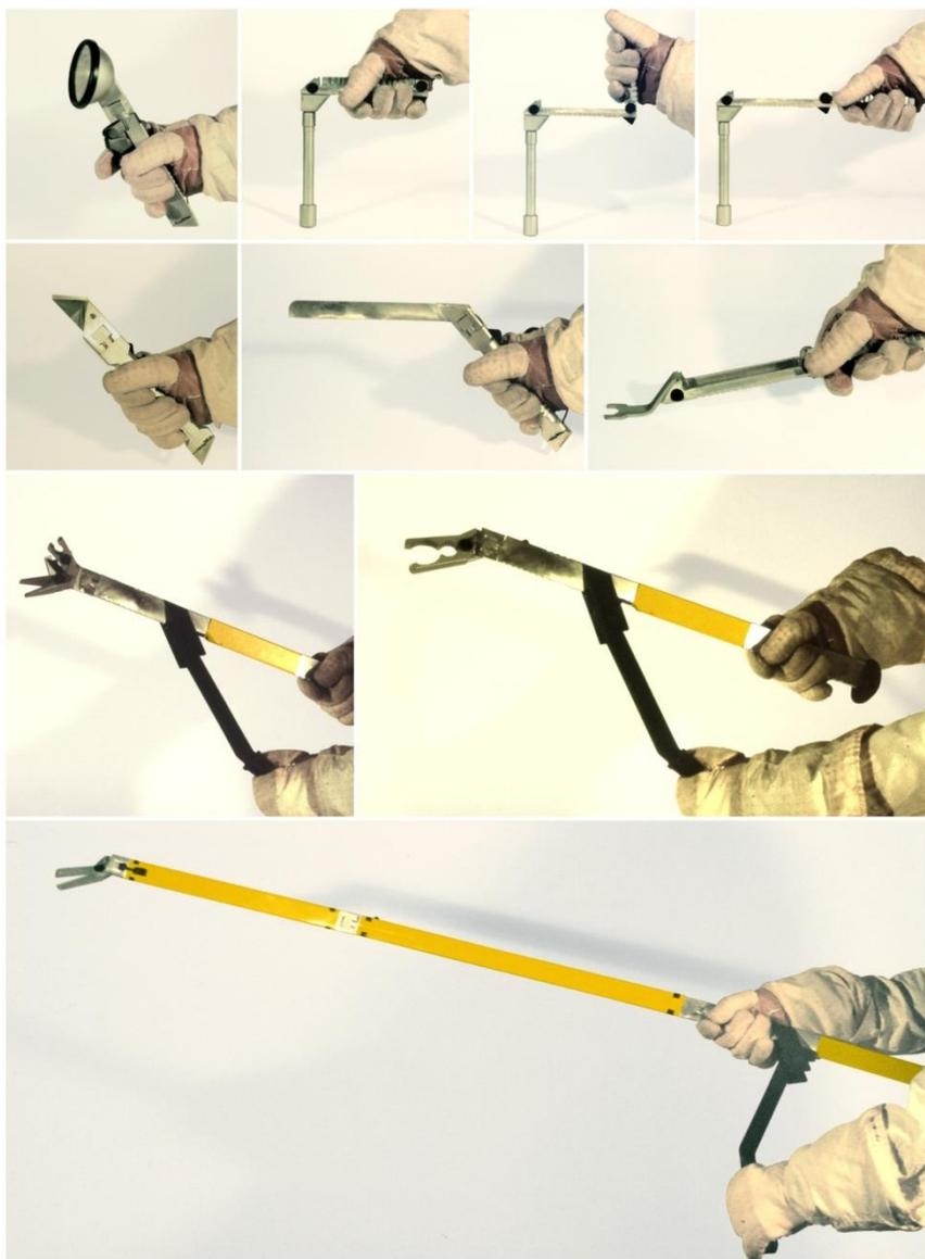
Рис.11d. Вариант ручного инструмента для работ в спец.снаряжении.
