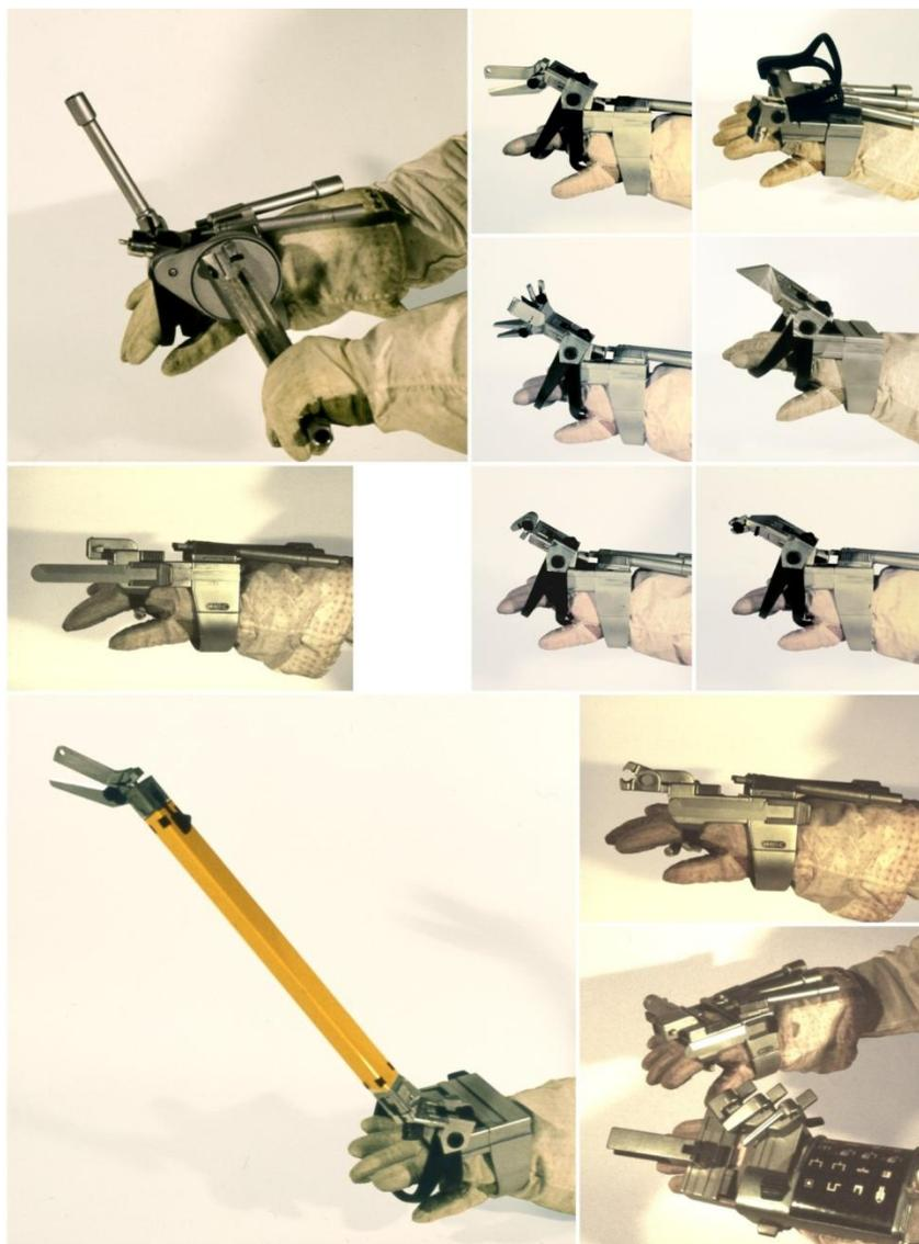
Рис.12е. Вариант наручного инструмента для работ в скафандре.
