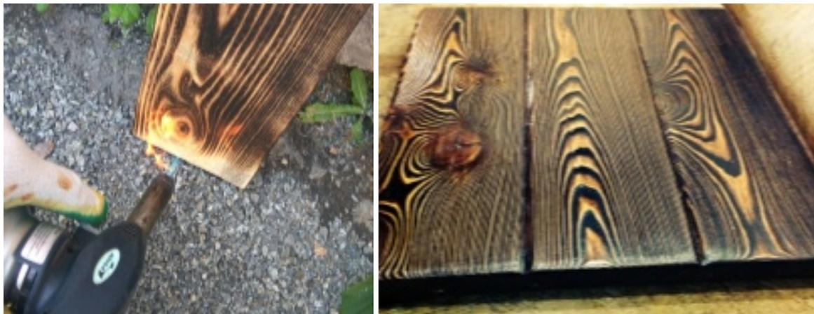
Ил. 4.14 Обработка древесины обжигом
